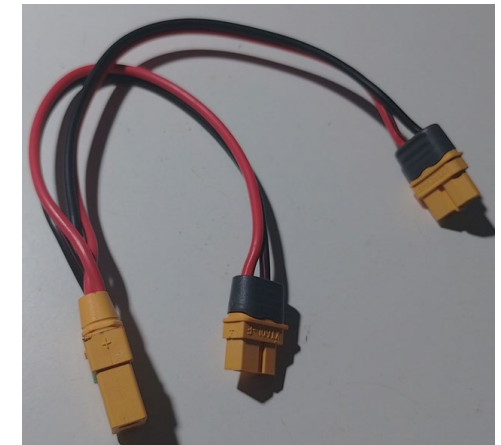
Шнур XT90/XT60 для підключення двох зарядних ToolkitRC для заряджання FPV дронів
